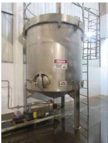
NR 999 - TANQUE HOMOGENEIZAÇÃO DE SANGUE CAP. 5000 L THOR
