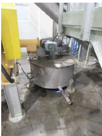
NR 999 - TANQUE COLETOR ÓLEO/SEBO CAP. 300 L THOR
