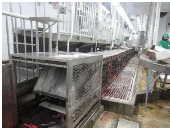
NR 999 - MESA ROLANTE PARA INSPEÇÃO DE VÍSCERAS SUÍNAS SULMAQ
