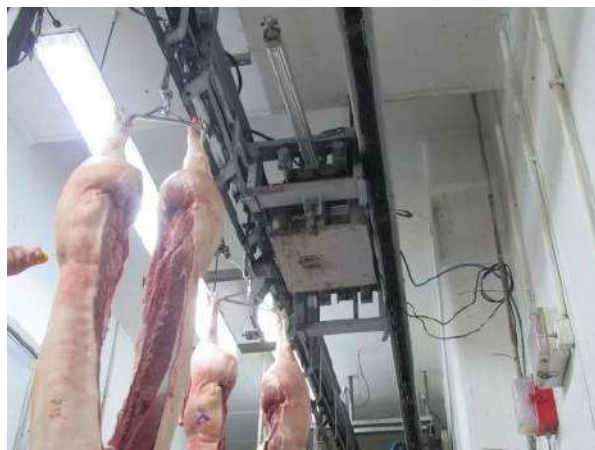
NR 999 - BALANÇA DINÂMICA DE CARÇAÇAS SULMAQ
