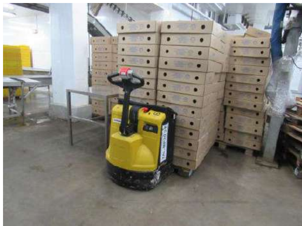
NR 999 - TRANSPALETEIRA ELÉTRICA CAP. 2000 KG YALE
