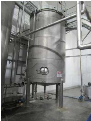
NR 999 - TANQUE DE EXPEDIÇÃO DE BANHA CAP. 20000 L THOR
