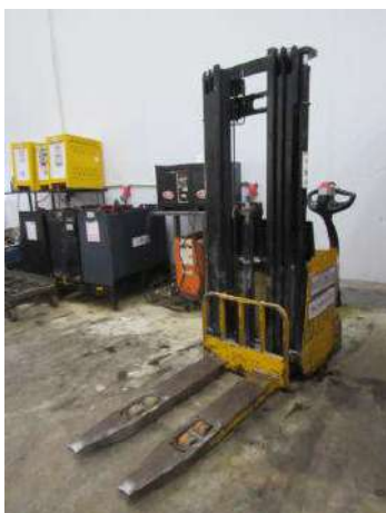
NR 999 - TRANSPALETEIRA ELÉTRICA CAP. 1600 KG YALE
