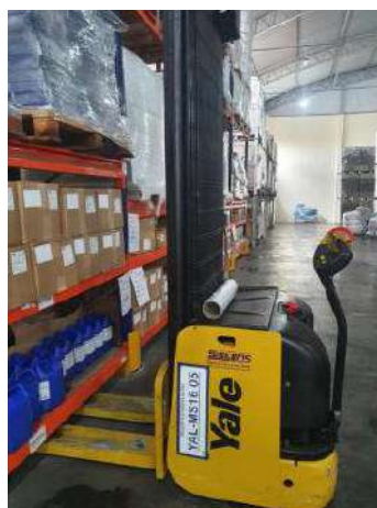
NR 999 - TRANSPALETEIRA ELÉTRICA CAP. 1600 KG YALE
