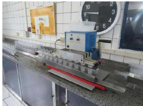
NR 121 - SELADORA SEMI AUTOMÁTICA POT. 650 W MINITUBE
