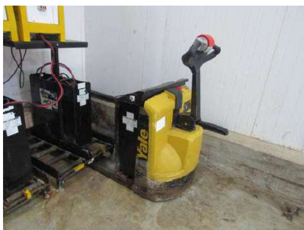
NR 999 - TRANSPALETEIRA ELÉTRICA CAP. 2000 KG YALE
