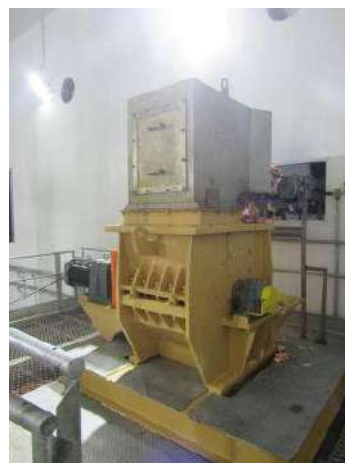
NR 999 - TRITURADOR PAEA BLOCOS CONGELADOS DE BANHA CAP. 6 TON/H THOR
